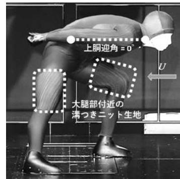
図 1 人形風洞実験
